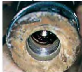
图9: 螺杆体端面不完全密封以及螺槽孔内的降解熔料
