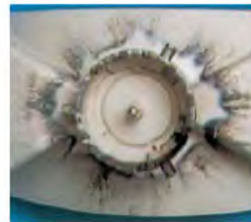
图10: 由于熔料降解, 制品呈现的严重变色
